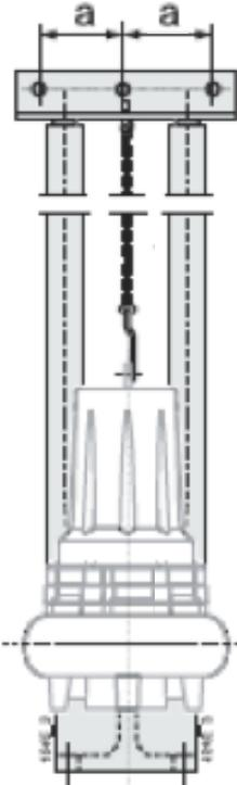
Dank des Doppelstangensystems von Caprari ist sichergestellt, dass die Pumpen problemlos gezogen werden können. Es findet kein Verdrehen statt und die Pumpen sitzen immer perfekt auf dem Pumpenfuß.
