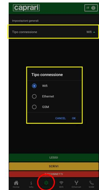
8. Per configurare i parametri di connessione occorre premere i pulsanti presenti nella parte inferiore della schermata, evidenziati in giallo. Questi possono essere di tre tipi:
