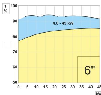
Wirkungsgrad von MMP-Synchronmotoren
