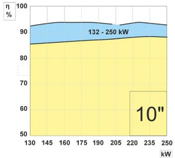
Wirkungsgrad von MMP-Synchronmotoren
