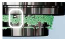
Sistema antisedimentación de los cuerpos sólidos
