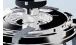
Système de découpe des fibres à l'arrière de la roue
